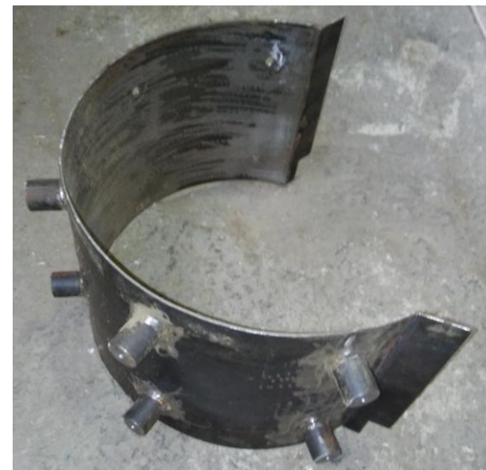
Mantaua rotorului răcitorului RTC
