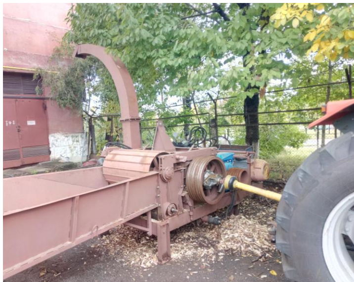
Vederea generală a toculatorului de resturi lemnoase TRL conectat la APP tractorului
